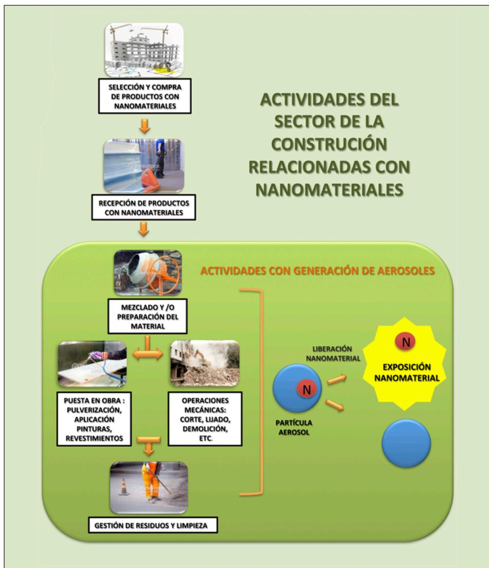
Figura 2. Posibles rutas de exposición durante el ciclo de vida de los nanomateriales en el sector de la Construcción.
